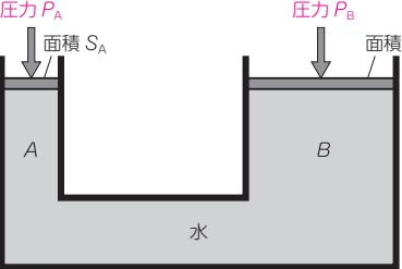
$\frac{\text{圧力 } P_A}{\text{面積 } S_A} = \frac{\text{圧力 } P_B}{\text{面積 } S_B}$ |
