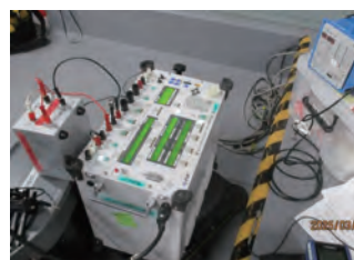
複巻変圧器での試験
