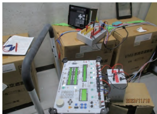
第11図 RX47022を用いた試験（複巻変圧器）
